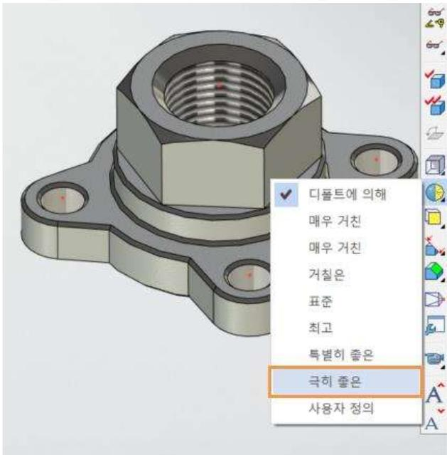
**i** 모델 이미지의 품질이 높을수록 평면형 면 수가 증가하여 대형 모델이나 성능이 부족한 비디오 카드의 작업 속도가 느려집니다. 가능하면 모델 이미지의 품질을 최소화하는 것이 좋습니다. 실사 이미지와 STL 또는 메시 형식으로 내보내는 동안에는 고품질이 권장됩니다.
