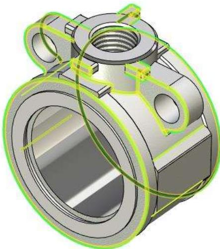
다음으로 3D 모델 창에서 핸들을 선택하고 장면에만 표시합니다. 에지의 혼합 작업을 수행합니다:
