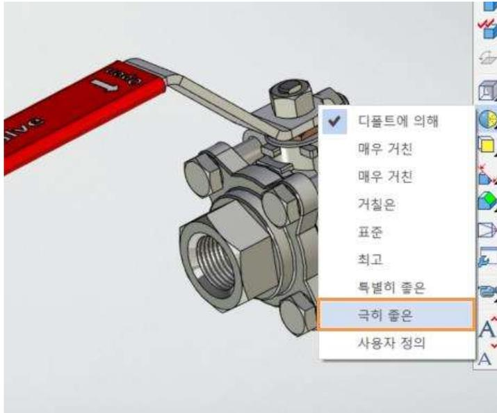
**i** **이미지 품질** 설정은 시스템 성능과 파일 크기에 영향을줍니다. 품질이 높을수록 3D 모델 처리에 더 많은 리소스가 소비됩니다. 또한 파라미터는 메쉬 형식 (예: [STL](#))으로 내보낼 때 메쉬의 품질에 영향을 미치고 실사 이미지를 만들 때 사진 품질에 영향을줍니다.
