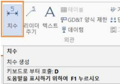
그림과 같이 2 개의 선을
