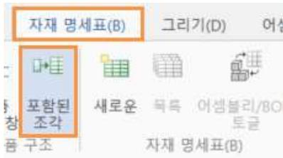
이 창에는 기존의 모든 조각 목록이 표시되며 제품 구조에 포함되는 모드를 지정할 수 있습니다. 목록의 각 요소에 대해 제품 구조에 포함하는 방법을 지정하거나 Ctrl 또는 Shift 키를 사용하여 다중 선택을 사용할 수 있습니다. 이 방법은 어셈블리가 이미 형성되어 있고 모델에 조각이 있을 때 사용하기 편리합니다.
